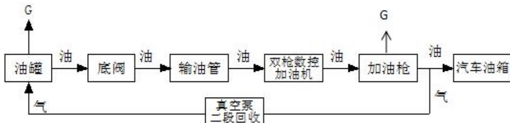
图 5-2 加油工艺及污染流程图
